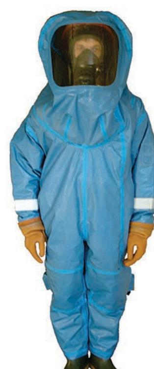
Предназначено для защиты в условиях первой зоны заражения, используется с изолирующими средствами защиты органов дыхания. Конструкция СИЗ-ИП обеспечивает укрытие кожных покровов и герметичность пользователя. Усиление защитных свойств комплекта обеспечивается созданием избыточного давления воздуха, поступающего в подкостюмное пространство
