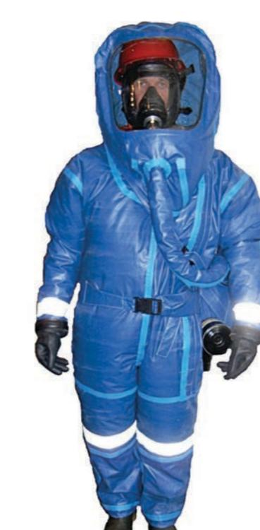
Предназначено для защиты в условиях второй и третьей зон заражения. Используется с фильтрующими средствами защиты органов дыхания. Реализован принцип разделенного расположения лицевой части и источника очищенного воздуха. Имеет узел очистки и подачи воздуха для дыхания и вентиляции подкостюмного пространства
