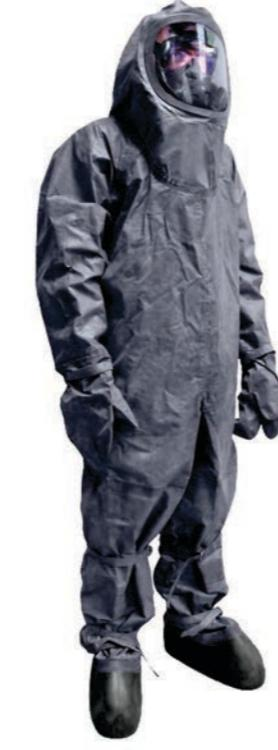
Предназначен для защиты от воздействия жидкого и газообразного хлора, аммиака и др. агрессивных химических веществ при проведении аварийно-спасательных работ. КИХ-5М состоит из герметичного комбинезона с трехпалыми перчатками, притачным капюшоном, в лицевую часть которого вклеено панорамное стекло. В комплект поставки входят хлопчатобумажные перчатки. КИХ-5М используется в сочетании с противогазом ИП-4М
